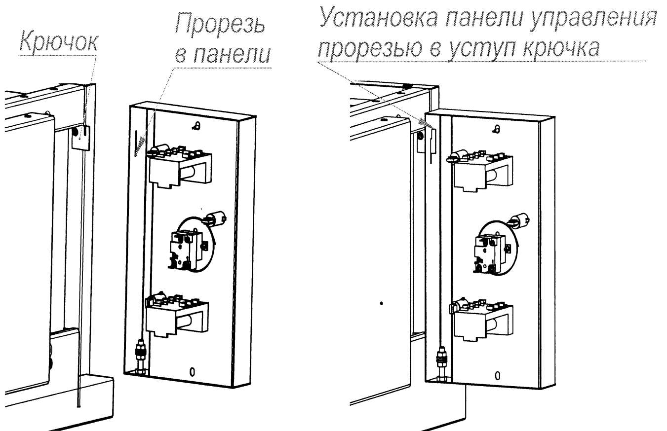
Рис.5 Схема установки панели управления при ТО
